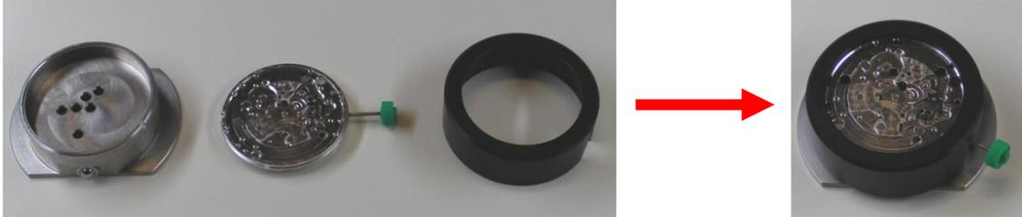
**IMPORTANT !!** Afin d'assurer une mesure correcte de l'ébat, il est capital que le **mouvement soit complètement désarmé**. Afin d'assurer qu'aucune tension résiduelle n'est présente dans le mouvement, il est recommandé de désarmer manuellement le mouvement. Des tensions résiduelles peuvent exister malgré un arrêt complet du balancier. De plus, l'utilisateur veillera à ce que le mouvement soit fermement maintenu par le couvercle dans le posage.
