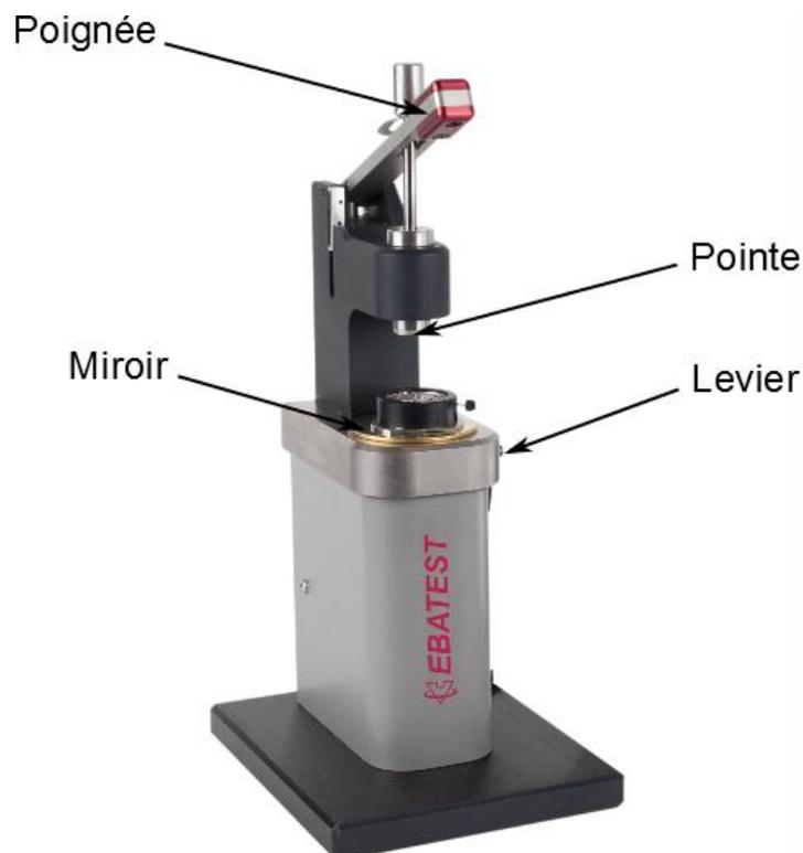
La poignée permet de descendre la pointe (voir chap. 3). Le miroir permet de placer aisément le porte-pièce sur l'EBATEST. Le levier permet de libérer la contre-pointe lorsqu'on veut changer celle-ci.
