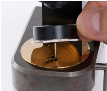
4. Maintenir le mouvement par la bague à l'aide de deux doigts situés de part et d'autre de la position mesurée.
